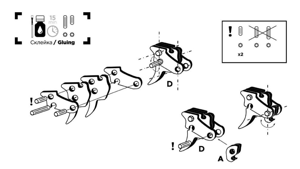
При склеивании детали D следите, чтобы клей не попал на шкант После склеивания деталей вытащите шканты
